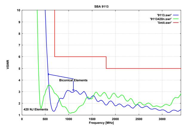
Zur Funktionskontrolle der SBA 9113 kann die Messung des Stehwellenverhältnisses an der N-Buchse der Antenne angewendet werden. Hierzu müssen die Antennenelemente (entweder Original-Bikonuselemente oder 420 NJ-Elemente montiert sein).
